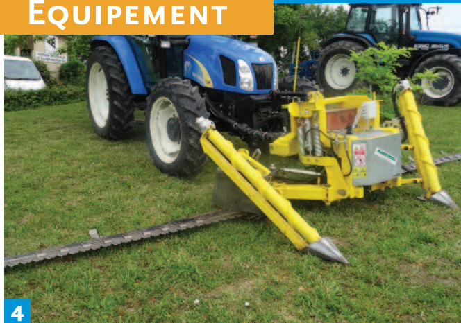
La coupe ALBERTAZZI : cette machine travaille également à plat, mais a l'avantage de relever les bordures de rangs sur cultures versées.
