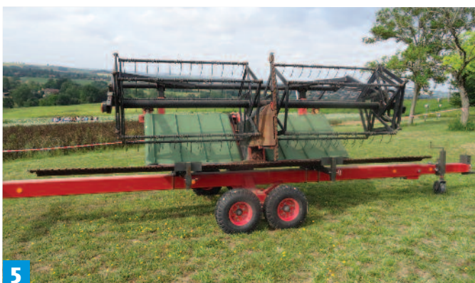
Pick-up adaptable sur la coupe : ce système simple à tapis est proposé en différentes largeurs de reprise.
