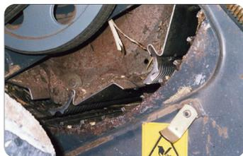
Pour un batteur conventionnel, le serrage doit être convergent c'est-à-dire plus étroit à l'arrière qu'à l'avant. L'optimum est de 25 mm à l'avant pour 12 mm à l'arrière.
