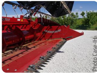
La profondeur entre le lamier et la vis de reprise doit être assez importante pour absorber la végétation
