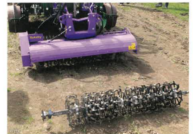
L'outil Rukaby permet d'interchanger rapidement les jeux de disques pour éviter de régler l'ensemble en passant d'une culture à l'autre. →
