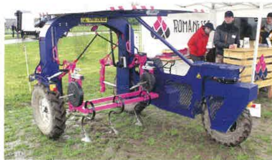
Le lit de désherbage polyvalent Romanesco est issu d'un besoin de désherbage en carotte sur l'exploitation familiale.
