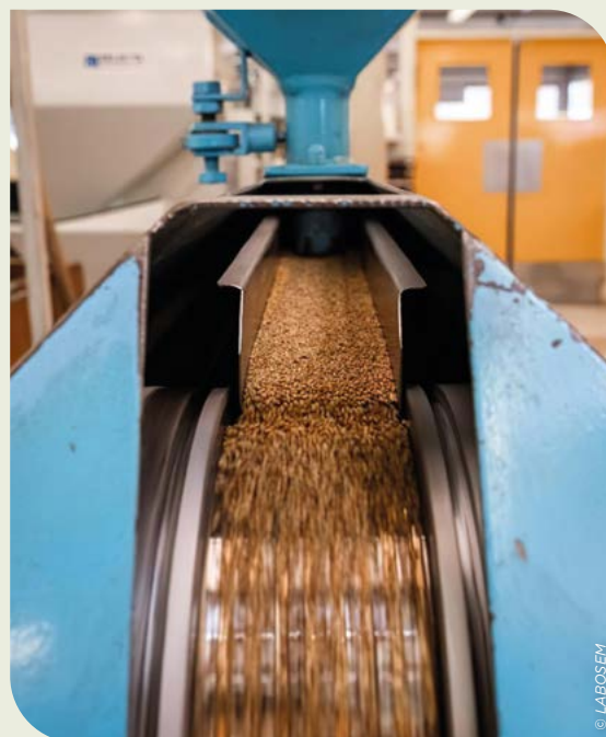
Triage spécifique à la magnétique pour éliminer la cuscute dans les semences de luzerne (micronettoyage à Labosem)
